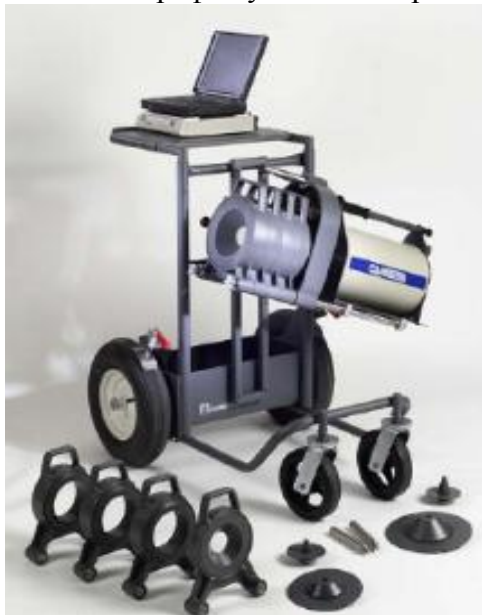
Рисунок 1 - Гамма-спектрометрическая система ISOCS
