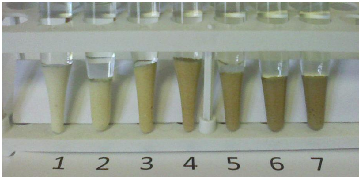
Интегральная доза облучения образцов, МГр: 1- 0; 2- 0,5; 3- 1; 4- 2; 5- 3; 6- 4; 7- 5. Рисунок 1 – Внешний вид исследуемых образцов анионита Lewatit MP-500
